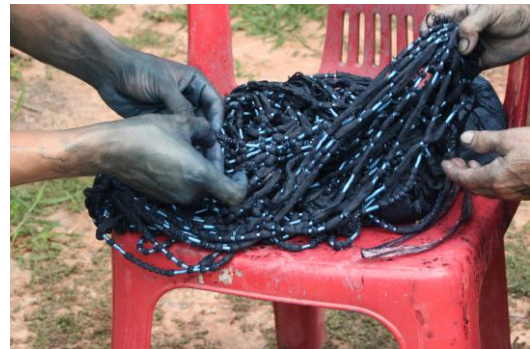
ภาพ 7 ผ้ามัดหมี่ลายดอกผักต้ว ที่ย้อมสีครามธรรมชาติแล้ว พร้อมนำไปล้างและแก้มหมี่ออก ก่อนสู่กระบวนการทอต่อไป
